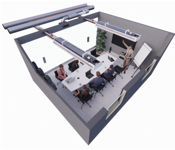
Kuva 22. Aktiiviset Halton Rex REE -ilmastointipalkit, joissa on HAQ-säädin ja PTS-säätöpelti ja joita ohjataan Halton Workplace WRA -huoneautomaatioyksiköillä
