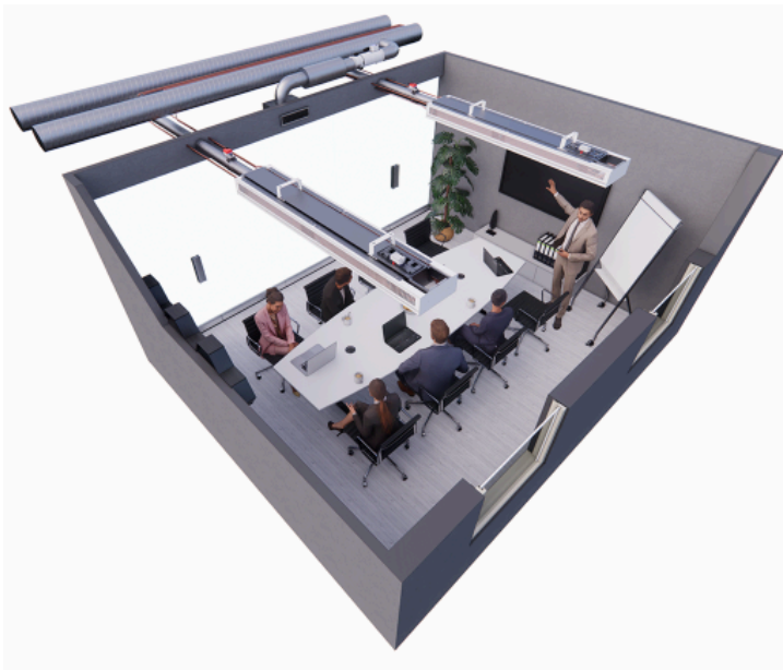
Fig. 22. Poutres climatiques actives Halton Rex REE avec système de contrôle HAQ et registre PTS, commandées par les contrôleurs d'automatisation de pièce Halton Workplace WRA
